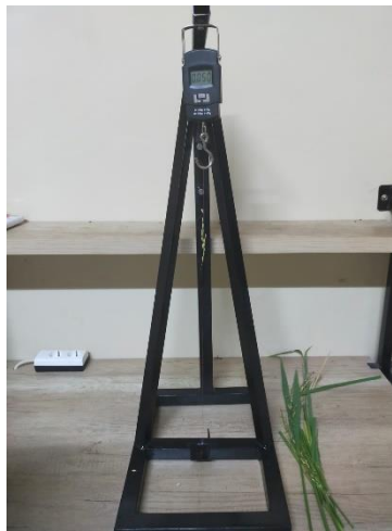
Gambar 5. Pengukuran nilai threshing force (TF) pada gabah padi varietas Ciherang dengan variasi kadar air menggunakan instrumen pengukur threshing force
